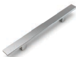
CO-111 Lunghezza: 500 mm Interasse: 300 mm Materiale: acciaio inox Finitura: cromo lucido
